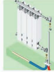
**Пресс-фитинги с хромированными стальными трубками отводами**
