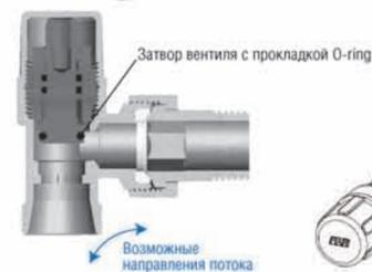
Настройка: пропускная способность пропорциональна числу оборотов  $Kv/Kv_{max} \approx N/N_{max}$
